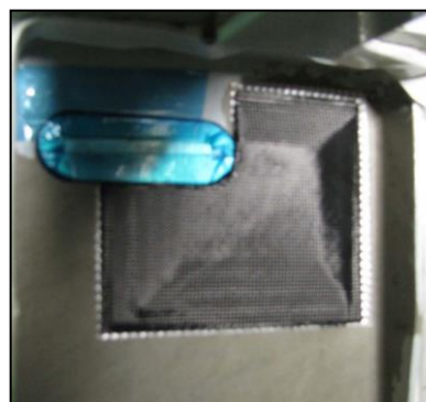
Рисунок 3: Ремонт алюминиевой балки пола ATR-72 с использованием приклеенной углеродной заплаты, выполненный на месте компанией GMI Aero, в сотрудничестве с компанией ATR.
