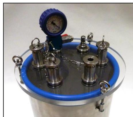
Рис. 1: Крышка на четыре канала без регулятора уровня вакуума
