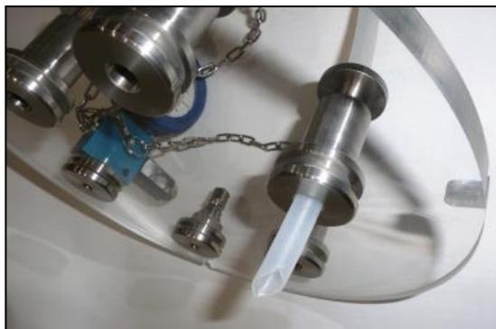
Рис. 3: Открытая крышка с зажатой трубкой
