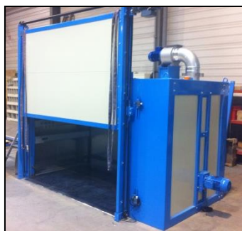
Печь: 2,1x1,1x1,3м, объём 3м 3 , Рабочая T=250°C
