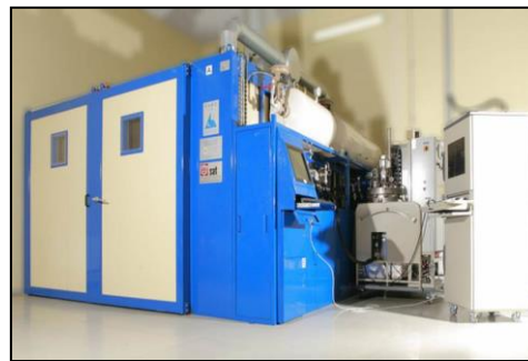
Печь: 3x4x2м, объём 24м 3 , Рабочая T=220°C
