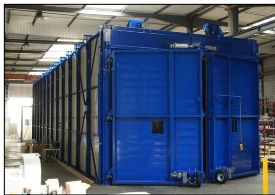
Печь: 5,5x6x3м, объём 99м 3 , Рабочая T=220°C
