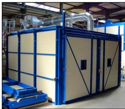
Печь: 6x22x4м, объём 528м 3 , Рабочая T=220°C
