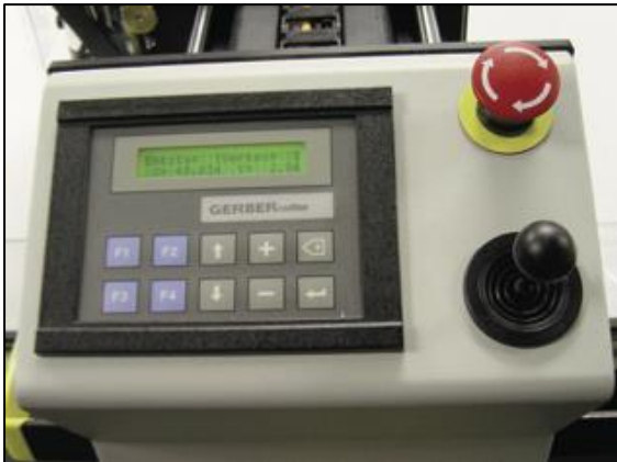
Сенсорная панель: с панели доступно большинство функций управления
