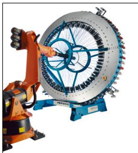
Плетельная машина радиального типа на 144 веретена с многоосевым манипулятором
